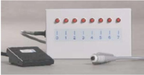
マーキングまたは精神生理学的な応答検査のための外部トリガー取得においてもリモートで使用します。デジタル入力チャンネルとしてスイッチデータを測定します。MP36/35 のデジタル入力にのみ接続してください。
