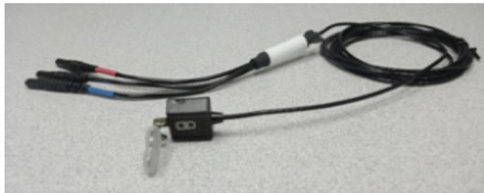
IR 検出器（フォトダイオード）は、赤外線エミッタから出力された光が入射することで動作します。入射光は、IR 検出器の制御電源のような役割を果たします。トランスデューサは、適切に動作する反射光の波長が範囲に収まるように自動で調整します。予想される入射光の大きさに対して、IR 検出器は線形的に動作します。検出器が非線形性（飽和近く）で動作する事はありません。
