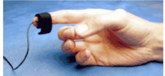
TSD200/SS4LA は、3m のシールド付きケーブルと指（または、身体のその他の部分にテープで留めることが可能）に簡単に取り付けするための伸縮性の Velcro® ストラップで構成されています。TSD200/SS4LA を指以外の箇所に固定する際は ADD208 電極用円形シールを使用して下さい。耳への装着に関しては、TSD200C イヤークリップを使用して下さい。
