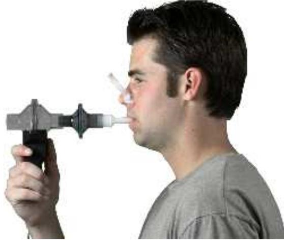
b) SS11LA 呼吸流量トランスデューサの“**Inlet**”とラベルが付いている側に常に挿入し、呼吸します。
