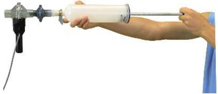
キャリブレーション用シリンジの適切な持ち方
