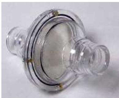
RX117A/RX117A-MRI は、TSD117A、TSD117A-MRI および SS11LB 呼吸流量トランスデューサ用の滅菌可能なフローヘッドです。フローヘッドに使用されている材料はアクリルで、しきりはステンレスです。使い捨て部品のコストを減らすには、AFT8 滅菌可能なマウスピースと RX117A/RX117A-MRI を使用してください。(22mm ID/30mm OD) 複数の RX117A-MRI ヘッドを交換する事で、洗浄の間の待ち時間を減らせます。
