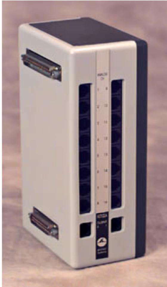
HLT100C モジュールは、MP システムに全ての高電位出力トランスデューサのインターフェースです。HLT100C モジュールには 16 個の入力および 2 つの出力チャンネルがございます。HLT100C は UIM100A ユニバーサルインターフェースモジュールの機能に似ていますが、接続の際、トランスデューサに電力も供給します。HLT100C への接続は、標準の 6 ピン RJ11 タイプのコネクタを介して行われています。
