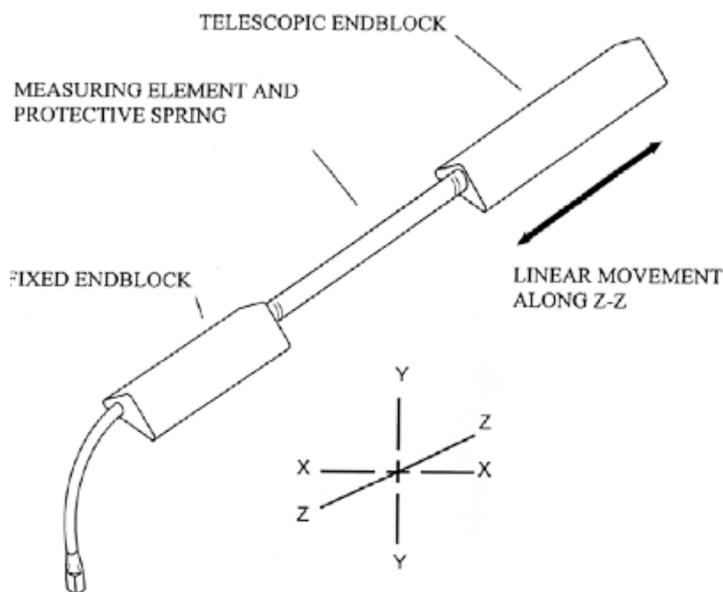
動作原理は、3種類のセンサ全てにおいて同様です。2つのエンドブロック間に取り付けられた保護用ばねのゲージ内に歪みを有している複合ワイヤがあります。2つの端部間の角度が変化するように、ワイヤの長さに沿った歪みの変化は測定され、角度に等しくなります。設計は、角変位のみが測定されるようなものとなります。
