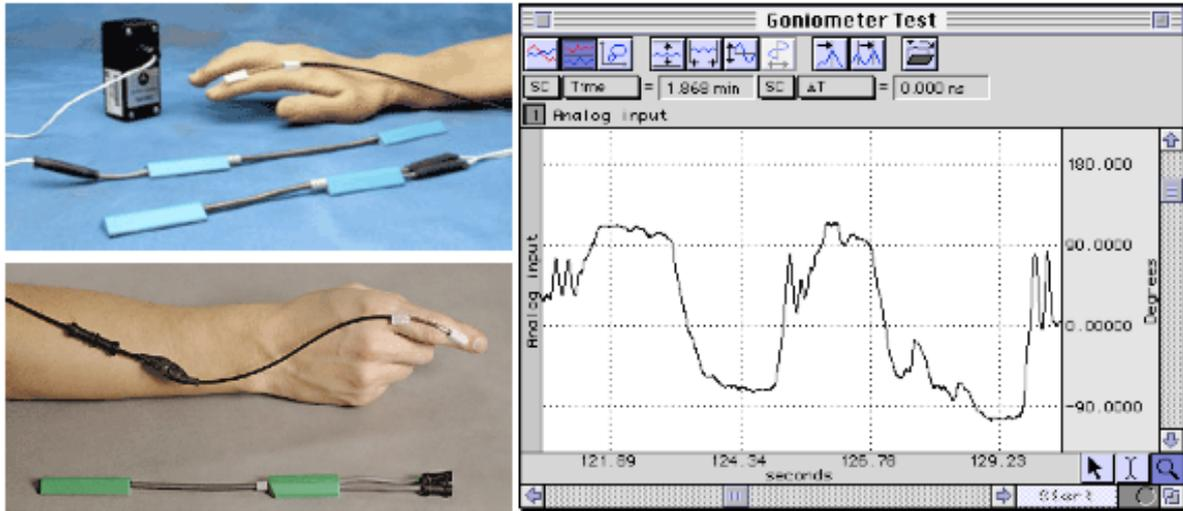
上記の例では、DA100C アンプに TSD130A が接続されており、DA100C のゲインは 1,000 に設定され、約  $+90^{\circ}$  ~  $-90^{\circ}$  の範囲で角度を測定する為に AcqKnowledge を使用しています。
