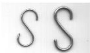
2 つのフックが TSD105A に付属しています。1 つは直径 .051" のワイヤーフック、もう 1 つが直径 .032" のワイヤーフックです。大きいフックは 500g、1000g を対象としており、小さいフックは 50g、100g、及び 20g の範囲に使用されます。
