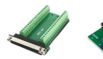
STP-I0 は、STP100C モジュールのアイソレートデジタル入出力ラインへアクセスするための端子台付きターミナルボードです。このデジタルブレイクアウトボードは、デジタル出力用のデジタルチャンネル 0~7 と、デジタル入力用デジタルチャンネル 8~15 へアクセスするため、STP100C の 37 ピンコネクタへ直接接続します。
