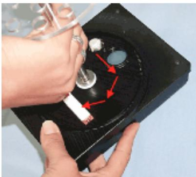
9) 透明のシリンダーをデバイス上にそっと戻し、電子基盤上のトラックにその下縁を置きます。
