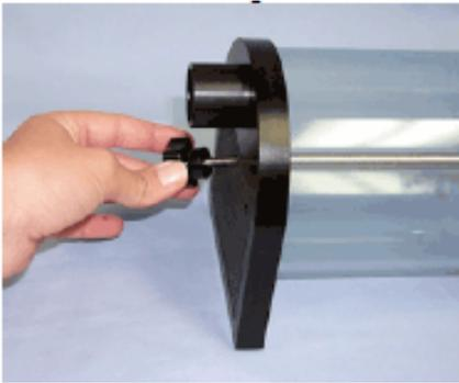
2) 流量チャンバからプラスチックの蓋を取り外します。
