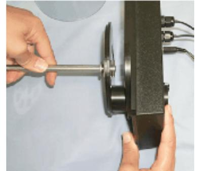
8) 固定ネジにラッチ開口部を仮置きし、ネジで位置を合わせた後に固定ロッドベースをセンサベースに押し付けます。
