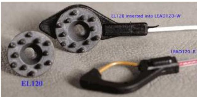
EL120 電極は、毛皮や髪の毛による接触抵抗を改善する為に設計された突起を有しています。12 個の突起から 10mm の接触面積が得られます。突起は皮膚表面との良好な接触のために、毛皮/髪の毛を押し分けるための 2mm の高さがあります。10 個入で出荷されます。
