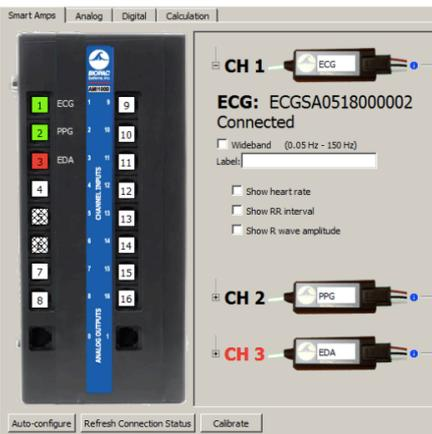
AMI100DはDシリーズアンプ専用のインターフェースです。モジュラージャック端子にアンプからダイレクトに接続します。接続するとAcqKnowledge上で自動認識。
