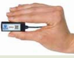
ERS100Dは誘発反应用アンプです。刺激による反応や、驚きによる反応、ABR反応、神経伝達速度などへ応用が可
